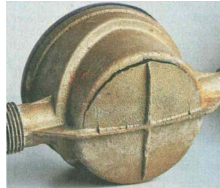
Frosttemperaturen haben diesen Wasserzähler platzen lassen.
